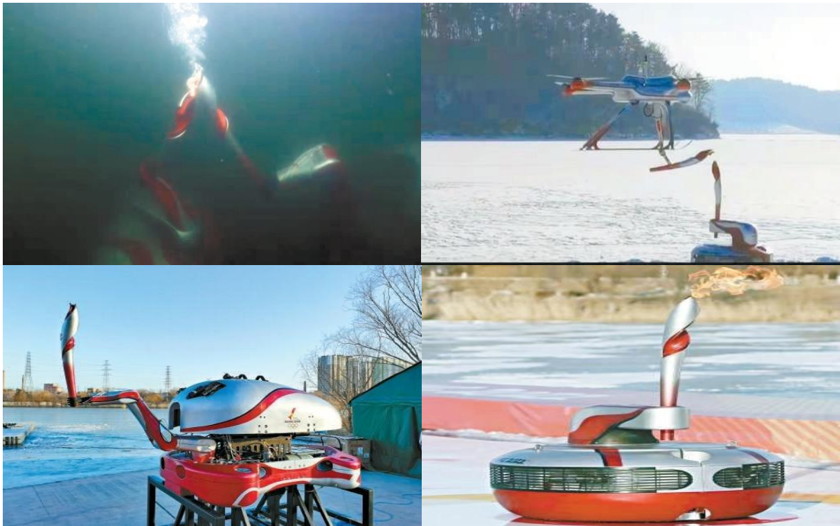
사진 3) 출처: 베이징일보(北京日报). 시계 방향으로 수중 가변 구조 로봇, 비행 로봇과 수륙양용로봇, 수륙양용로봇, 지상 이동 로봇
