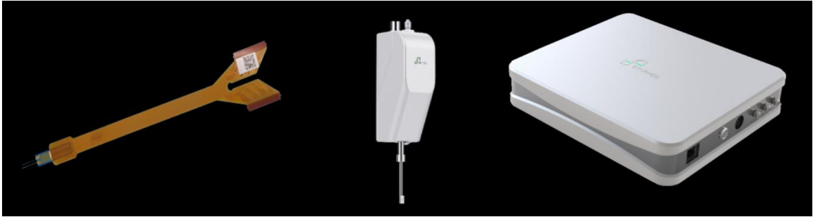
사진 1) 출처: STAIRMED(阶梯医疗) 사이트, 좌부터 초연성 마이크로 전극, 휴대형 삽입시스템, 고용량 신호 수집 시스템
