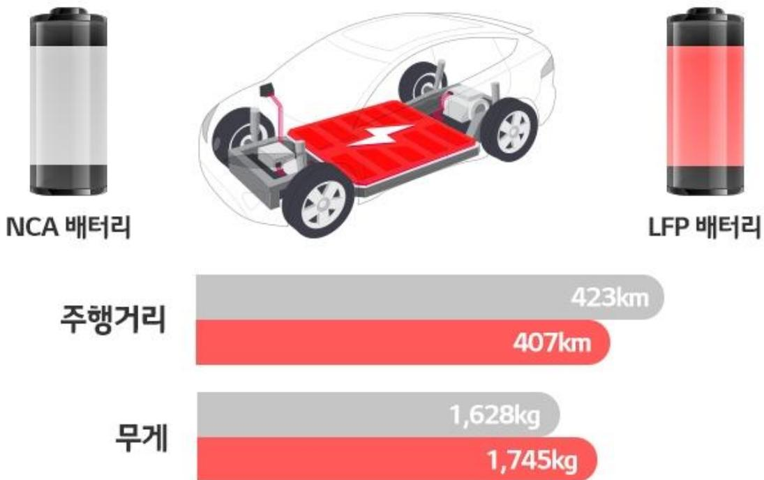
사진 1) 출처: LG 에너지솔루션, NCA 와 LFP 배터리 비교 도표
